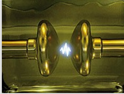
Test elektrické pevnosti oleje.
