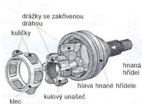
Pevný kuličkový kloub (Rzeppa-Birfield) – schéma a fotografie
