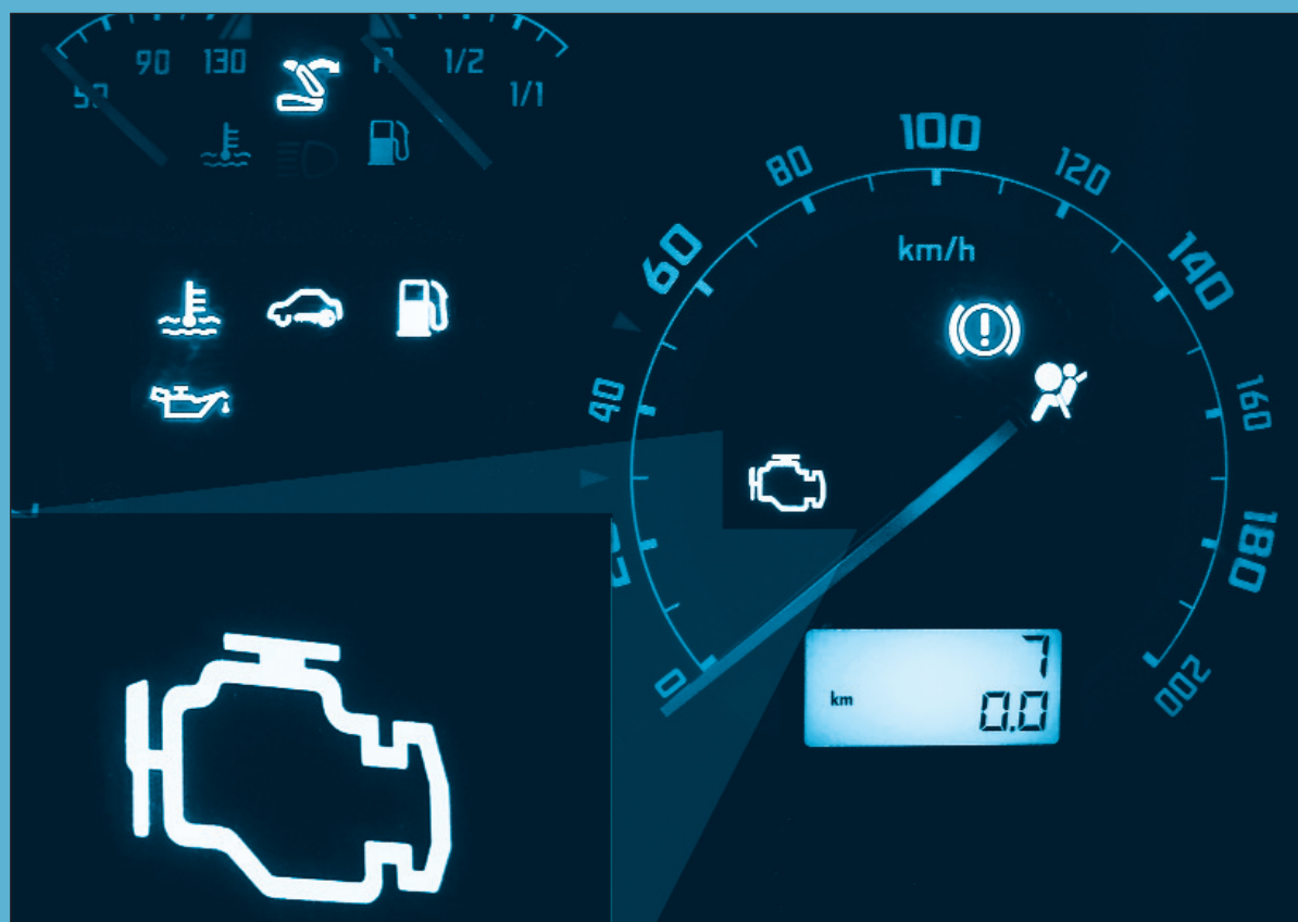
Obr. 20. Signálka závady používaná integrovaným systémem OBD.
