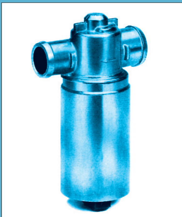
Obr. 6. Elektromagnetický stavěcí člen obtoku pro hadicové připojky.
