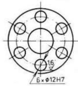
Obr. 80 Příklad předepisování drsnosti povrchu a umístování značek na výrobních výkresech
