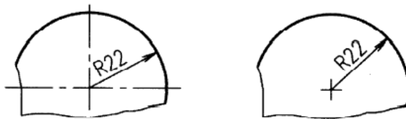
Obr. 26 Příklady kótování poloměrů
