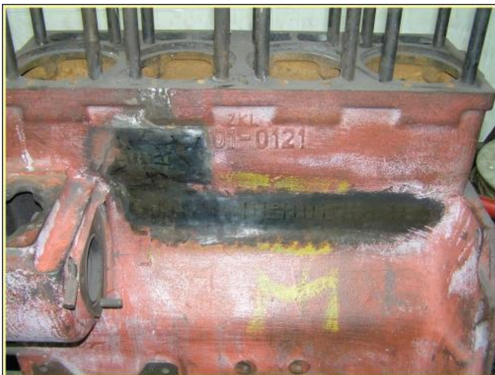
Obr. 3: Oprava prasklého bloku
