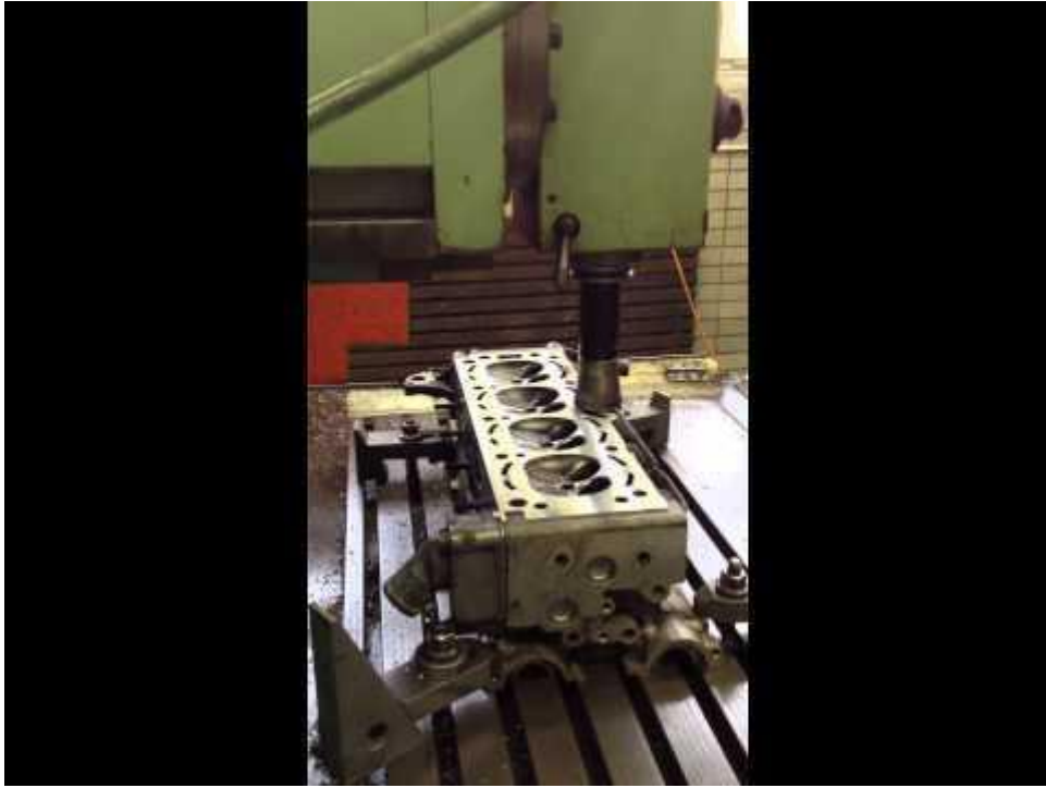
Obr. 4: Frézování plochy hlavy válců
